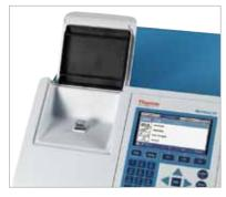
Multiskan GO accepts versatile cuvettes
